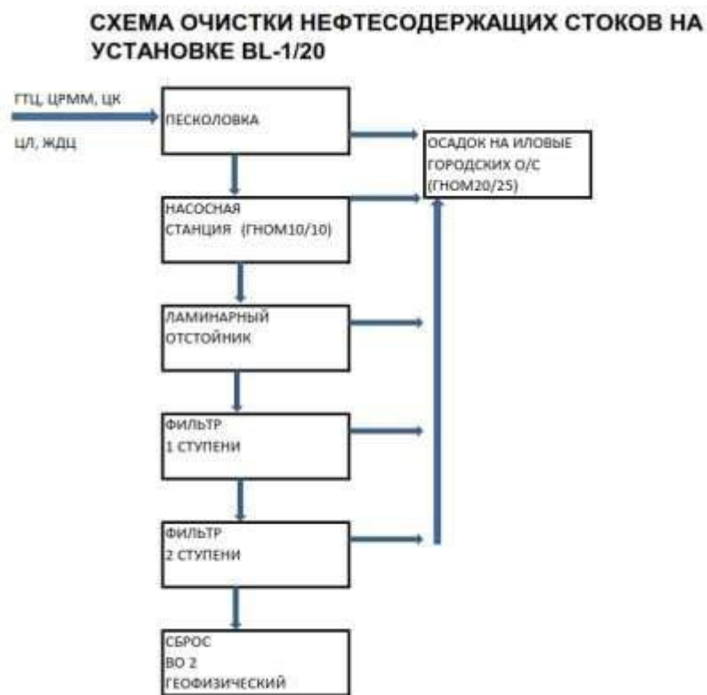
Рисунок 3 – Технологическая схема очистки производственных сточных вод Центральной площадки
