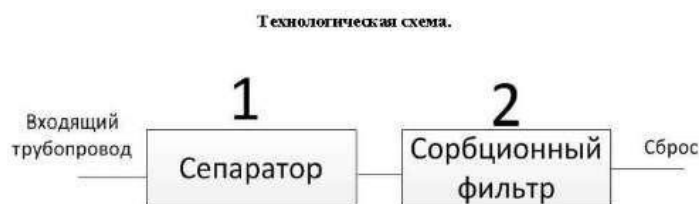
Рисунок 8 – Технологическая схема очистки дождевых сточных вод ШДНК
