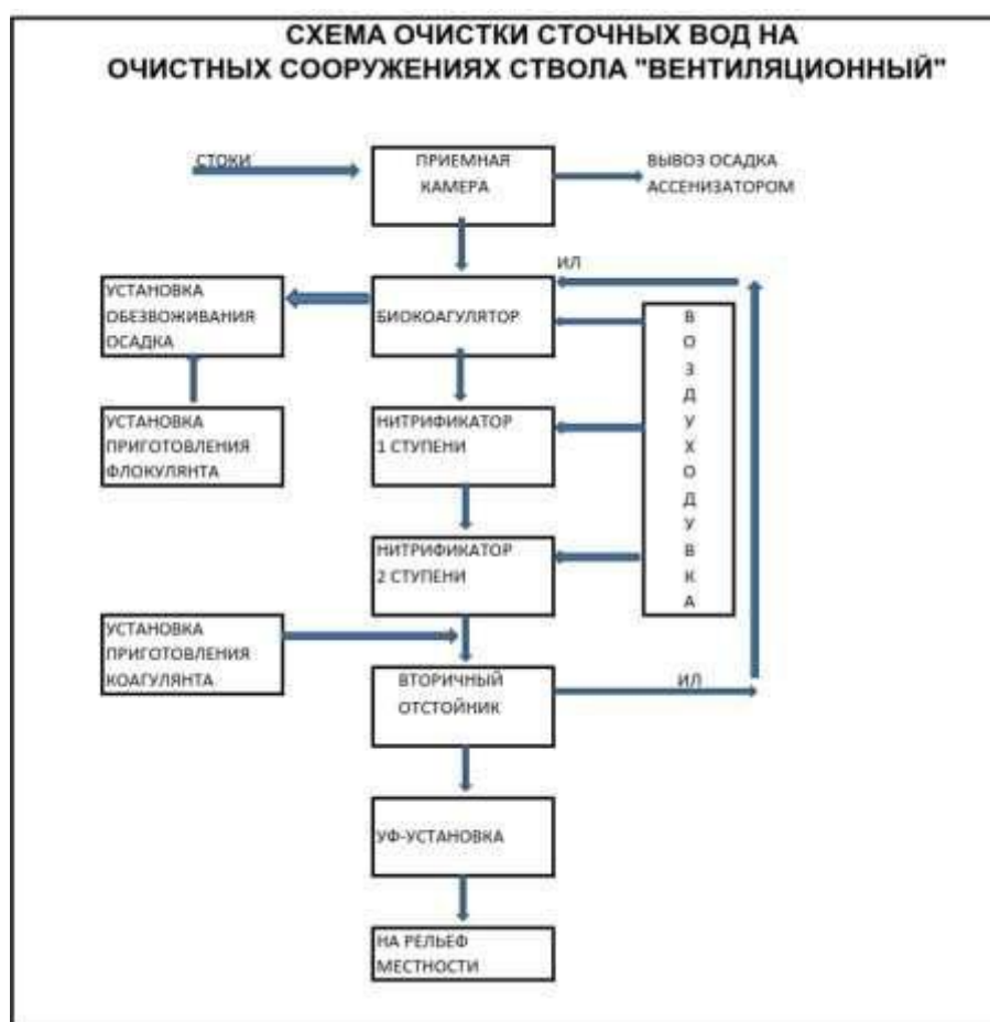
Рисунок 5 – Технологическая схема очистки бытовых сточных вод ШДНК
